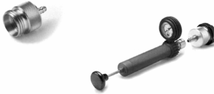
Pav.37 Išsiplėtimo indo kamščio tikrinimas
